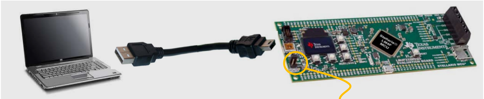
将 EK-LM4F232 连接至计算机
