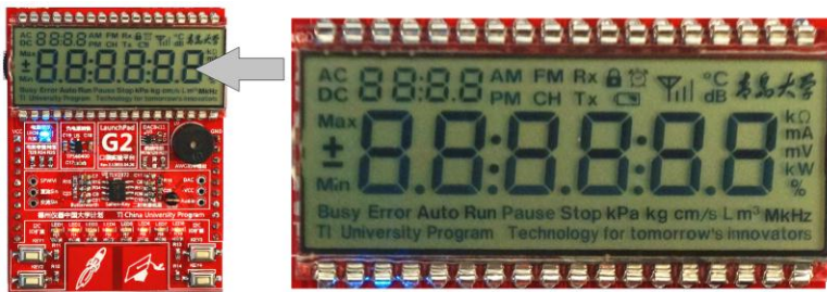
图 1.20 扩展板中所用的 128 段段式液晶
