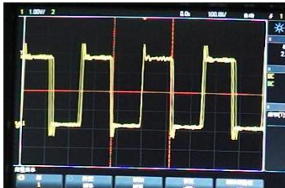
图 22.9 观测混频时钟的抖动
