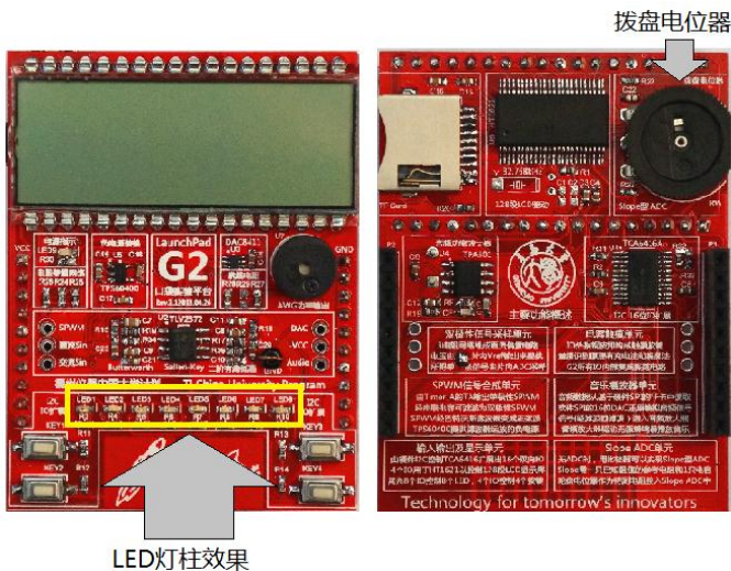
图 17.15 拨盘电位器控制 LED 的亮灭
