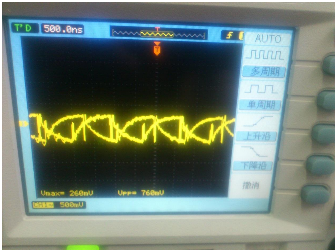
图 9 负载为 20 欧姆时的电压纹波
